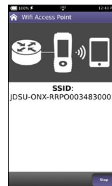
OneExpert DSL disponibilizando ponto de acesso Wi-Fi
